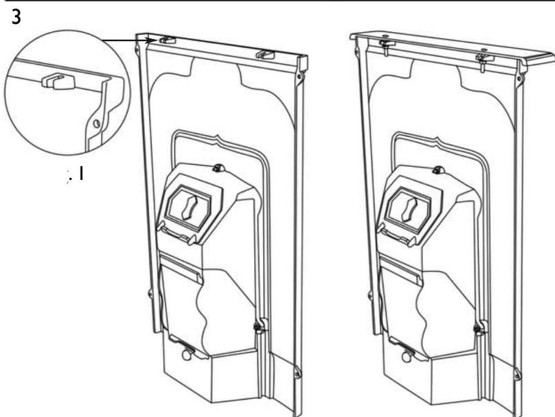
Положите каминную полку на камин и вставьте два болта M8 в отверстия на полке таким образом, чтобы они проходили через крепежные выступы (рис. 1) на обратной стороне камина. Для закрепления каминной полки следует использовать две шайбы M8 и 2 гайки M8, затянутые плоской отверткой.
