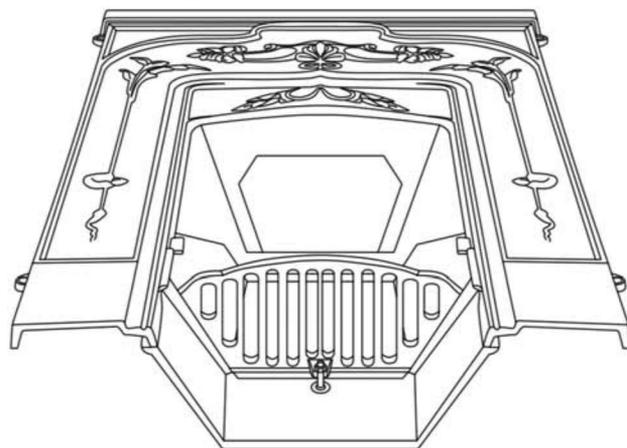
Вставьте колосник в пазы над гайкой M6. Закрепите на месте при помощи шайбы и болта M6.
